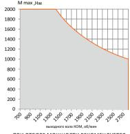
ПРИ ОТБОРЕ МОЩНОСТИ РЕКОМЕНДУЕТСЯ РЕЖИМ РАБОТЫ ДВИГАТЕЛЯ 1400...1700 ОБ/МИН
