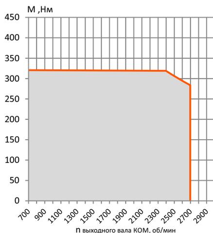
ПРИ ОТБОРЕ МОЩНОСТИ РЕКОМЕНДУЕТСЯ РЕЖИМ РАБОТЫ ДВИГАТЕЛЯ 1400...1700 ОБ/МИН
